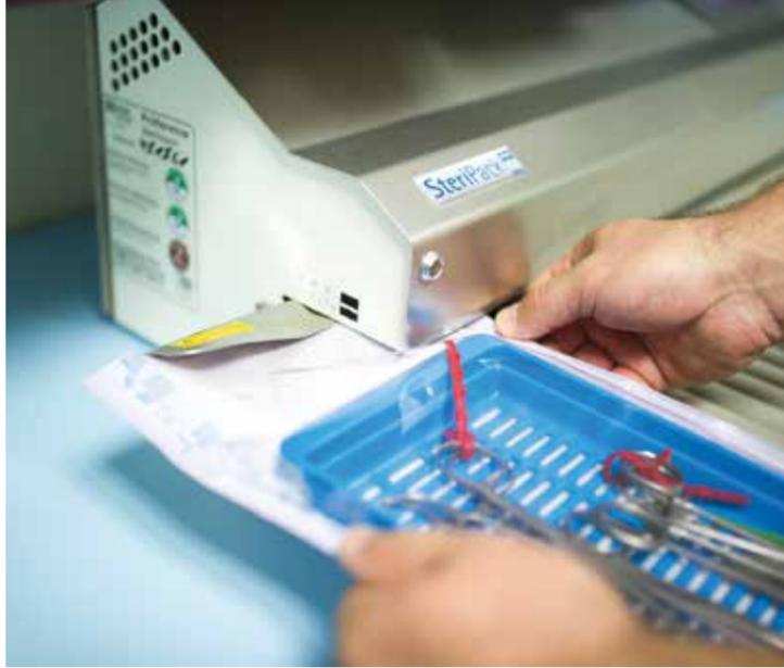
**150 Liter rauschen durch den Reinigungs- und Desinfektionsautomaten im Sterilisationsbereich der ATOS Klinik Heidelberg, und das ist erst der Anfang: Nach dem eineinhalbstündigen Waschgang bei 93 Grad werden Scheren, Meißel und anderes OP-Besteck durch eine Mitarbeiterin einzeln überprüft, verpackt und dann bei konstant 134 Grad fünf Minuten lang im Vakuum sterilisiert.**
